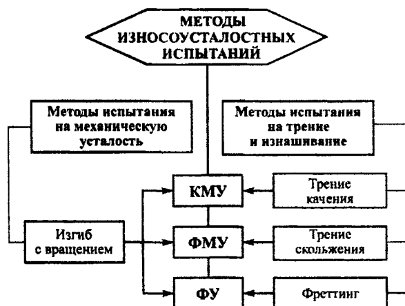
Рисунок 1 – Формирование методов износоусталостных испытаний при главном вращательном движении: КМУ – контактно-механическая усталость; ФМУ – фрикционно-механическая усталость; ФУ – фреттинг-усталость
