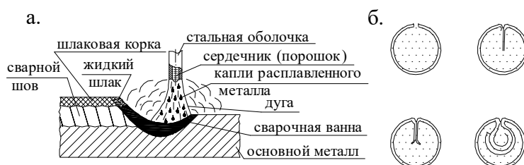
Рис. 2.7. Схема сварки порошковой проволокой (а); сечения порошковой проволоки (б)
