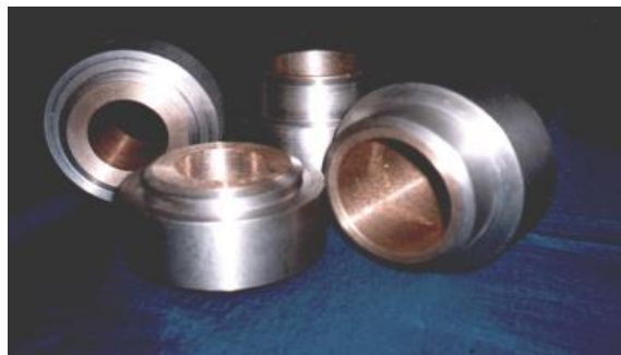
Рисунок 1 – Общий вид алюминий - медного композиционного материала и пример изделия на его основе
