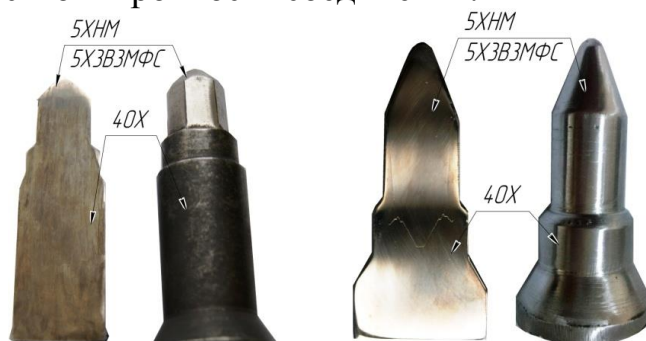
Рисунок 1 – Многоступенчатый биметаллический инструмент изготовленный методом СГВ
