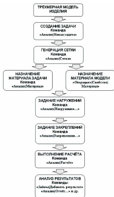
Рисунок 1 – Алгоритм моделирования процесса гибки
