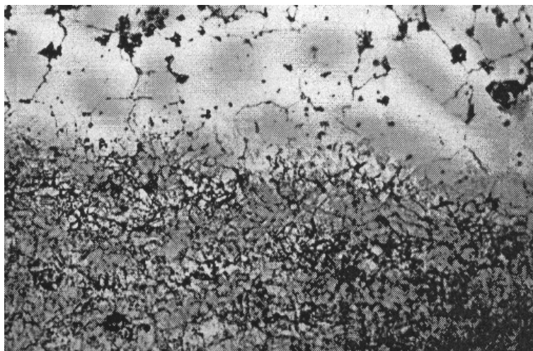
Рисунок 1 – Микроструктура двухслойного материала сталь 45 - ПА-БРОШ 10-2-3. х 200
