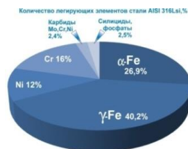
Рисунок 1– Диаграмма распределения количества легирующих элементов сварочной нержавеющей проволоки AISI 316Lsi .
