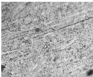
Рисунок 3 – Структура исследованного чугуна SCh20 в зоне оплавления, х990
