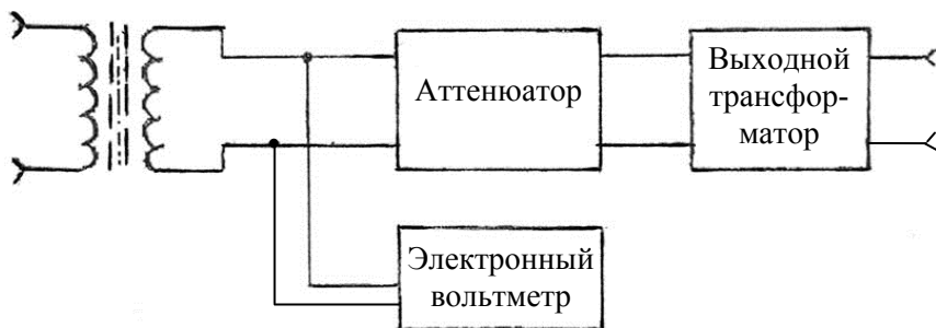
Рис. 19.2. Схема включения электронного вольтметра в тракт генератора низкой частоты
