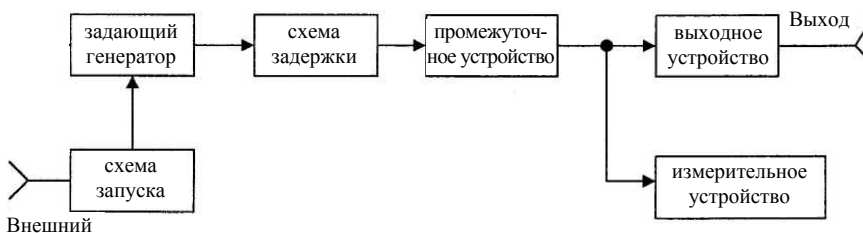
Рис. 19.3. Структурная схема импульсного генератора
