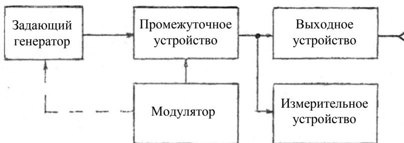
Рис. 1.2. Структурная схема измерительного генератора
