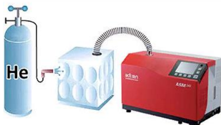
Рисунок 2 – Схема течеискания методом обдува
