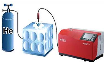
Рисунок 1 – Схема течеискания методом щупа
