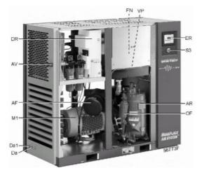
AF – воздушный фильтр; AR – воздушно-масляной резервуар; AV – выпускной вентиль сжатого воздуха; Da – патрубок автоматического слива конденсата; Da1 – патрубок автоматического слива конденсата из осущителя; DR – осущитель; ER – регулятор Electronicon 2; FN – охлаждающий вентиль; M1 – приводной двигатель; OF – масляный фильтр; VP –з аглушка вентиляционного отверстия
