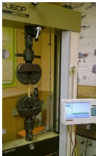
Рис. 4. Испытание на растяжение на разрывной машине ИР-5047-50
