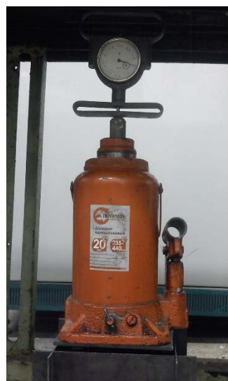
Рис. 3. Установка для выдержки изделия под нагрузкой
