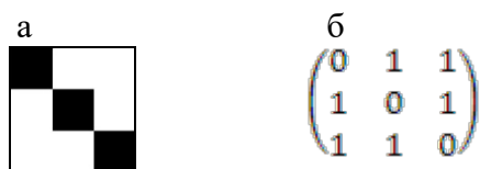
Рис. 1. Представление оцифрованного изображения квадрата (а) в матричном виде (б)
