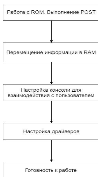
Рис. 2. Схема общей последовательности работы загрузчика.
