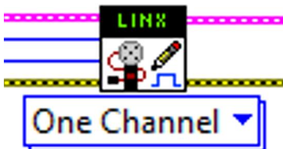
Рис 2. Элемент управления сервоприводом.
