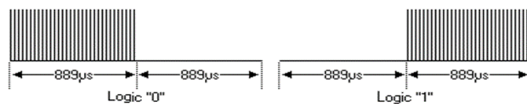
Рис.1. Бифазная модуляция протокола RC5.
