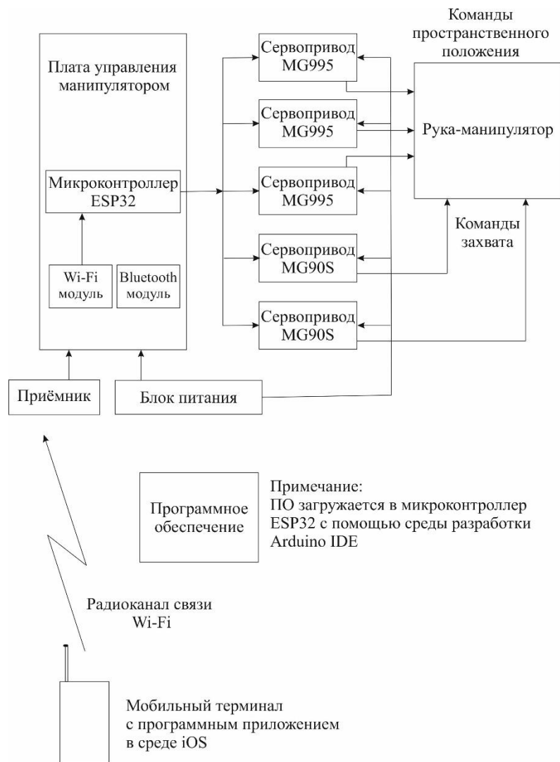
Рис. 1. Структурная схема мехатронной системы с шестью степенями свободы.
