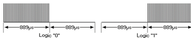
Рис.1. Бифазная модуляция протокола RC5.
