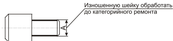
Рис. 1.4. Обозначение категорийных ремонтных размеров
