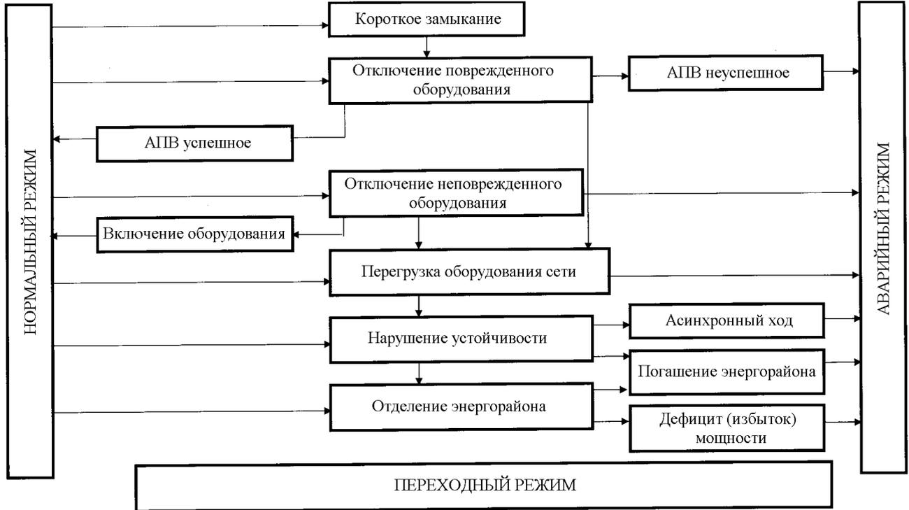
Рис. 4.2. Обобщенная схема аварийных процессов в энергосистеме
