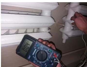
Рисунок 4- Показания мультиметра при прямом контакте с поверхностью радиатора
