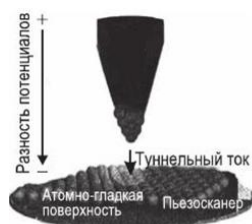
Рисунок 2 – Сканирующий зонд при измерении проводимости
