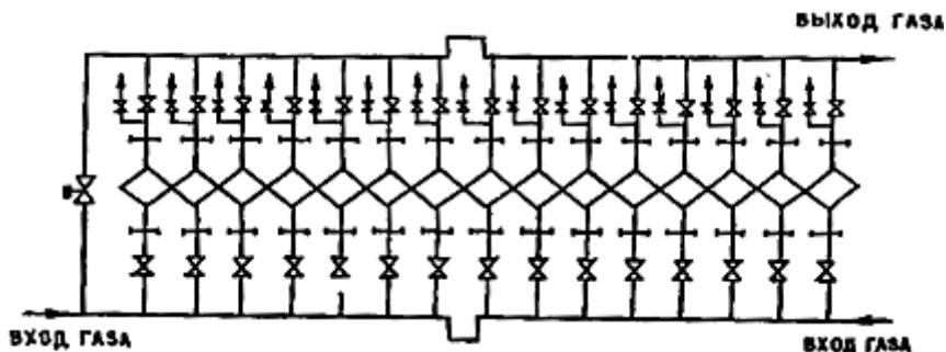
Рисунок 1 – Схема обвязки аппаратов воздушного охлаждения газа
