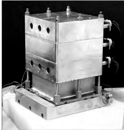
Рис. 4. Фотография нагревательной системы и системы охлаждения в собранном виде. Внешняя теплоизоляция снята
