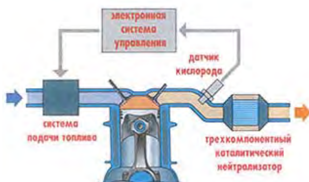
Рис. 2.5. Схема трехкомпонентной нейтрализации отработавших газов
