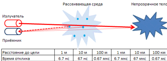
Рис. 73. Принцип работы импульсного дальномера
