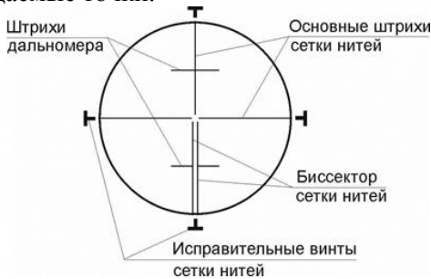
Рисунок 54 Сетка нитей зрительной трубы теодолитов Т30, 2Т30
