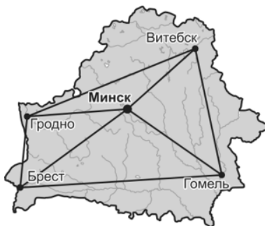
Рис. 28. Схема высокоточной геодезической сети (ВГС)
