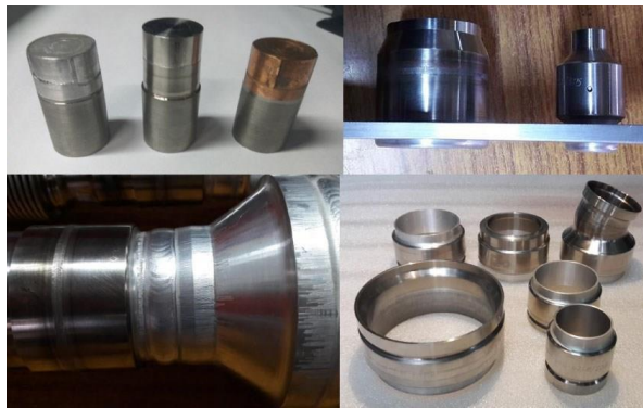
Рисунок 1 – Изделия из биметалла
