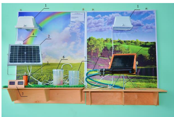
Рисунок 1.1 – Лабораторный стенд по изучению фотоэлектрических насосных станций с применением солнечных коллекторов для нагрева воды.
