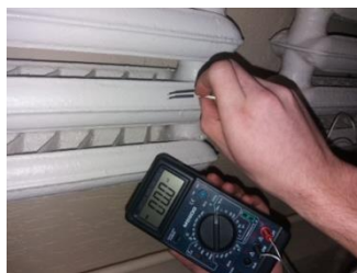
Рисунок 3 - Показания мультиметра при отсутствии прямого контакта с поверхностью радиатора
