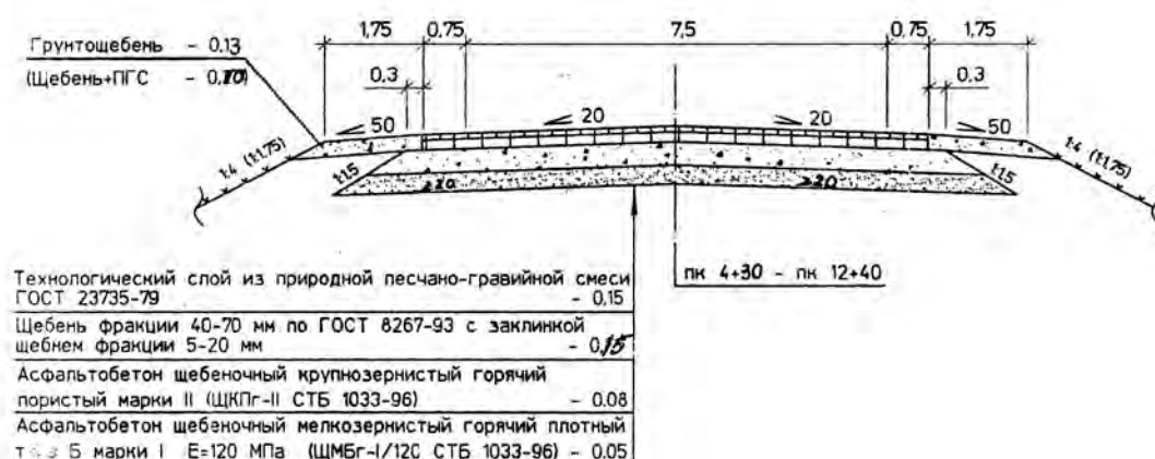
Рис. 1. Конструктивные элементы дорожной одежды
