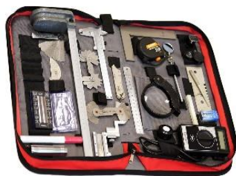
Рис. Оборудование для ВИК
