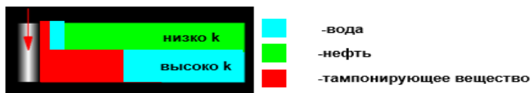
Рисунок 2 – Ситуация в пласте после закачки СПС
