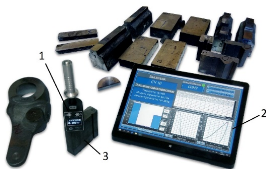
Рисунок 1 – Внешний вид прибора для контроля характеристик чугуна: 1 – датчик-твердомер ТПЦ-7; 2 – электронный блок; 3 – образец
