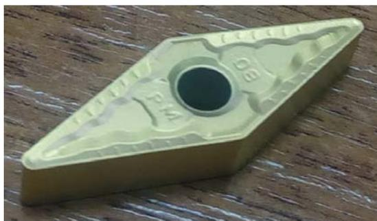
Рисунок 2 – Сменные твердосплавные пластины VNMG 160408
