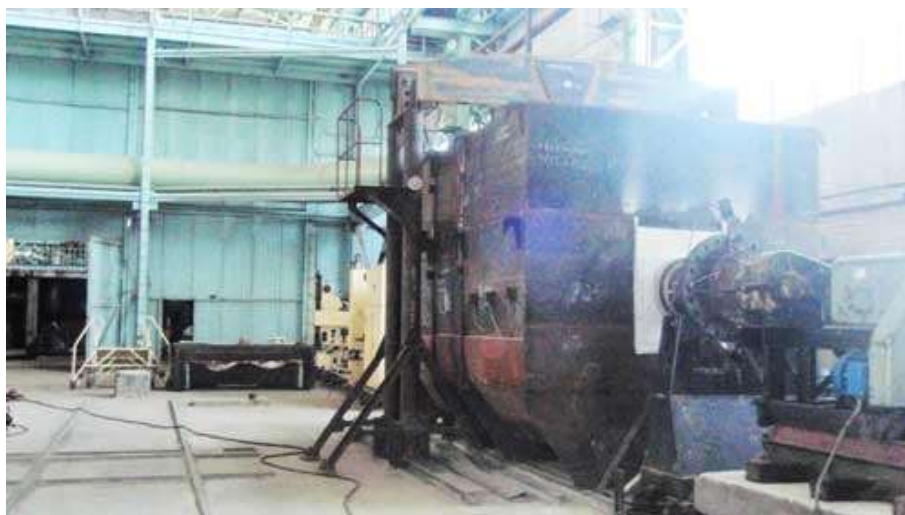
Рисунок 3. Установка для правки ротора методом релаксации ЗАО «Турбинист»
