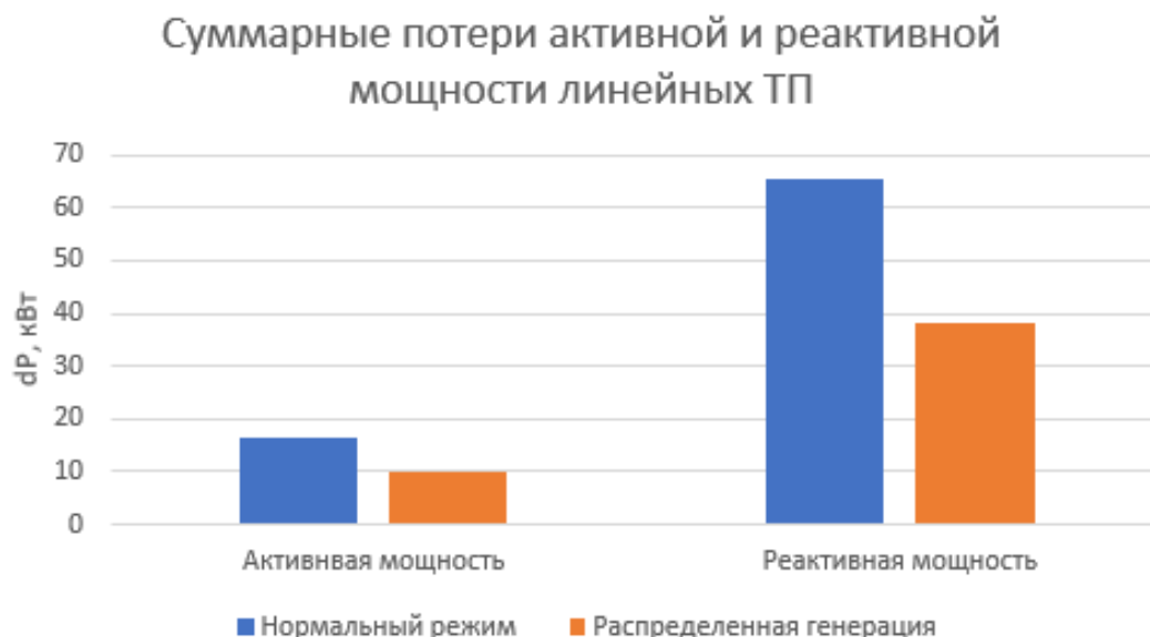
Рисунок 4 – Сравнение суммарных потерь в линейных ТП
