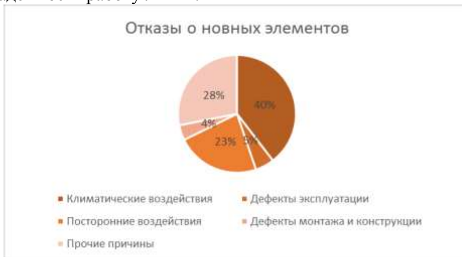
Рисунок 1. Распределение отказов основных элементов ВЛ 35-500 кВ по причинам в процентах к общему числу отказов
