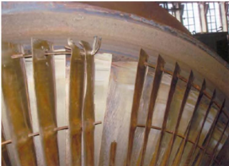
Рис. 1.19. Повреждения лопаток
