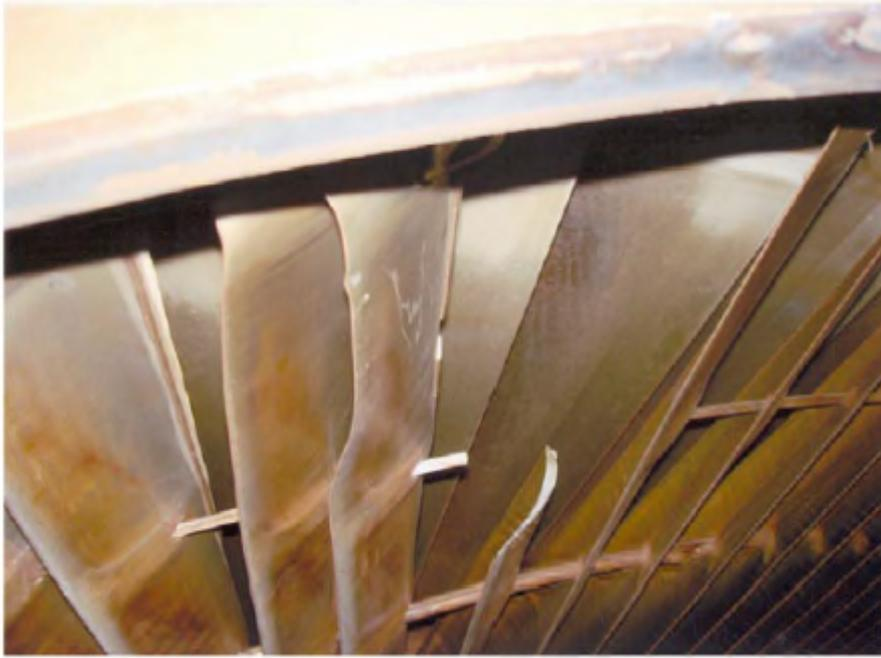
Рис. 1.18. Облом лопатки РНД
