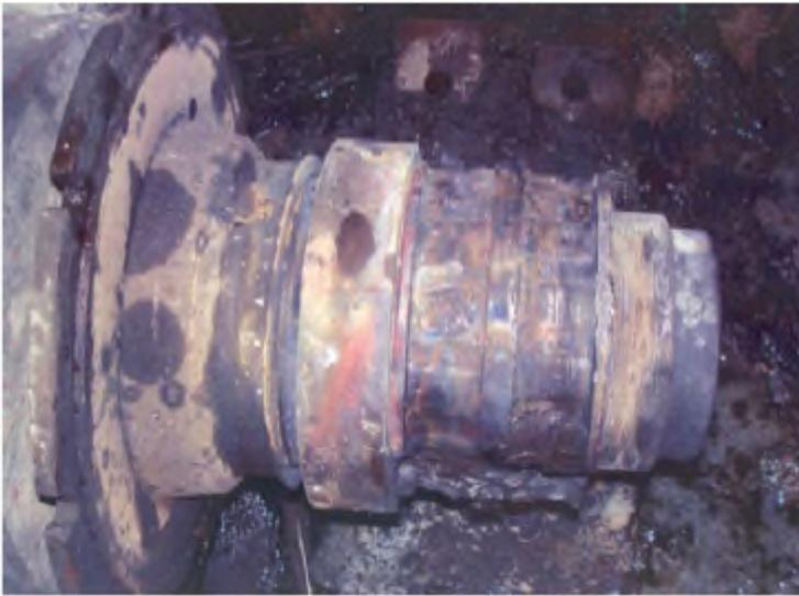
Рис. 1.34. Ротор поврежденного подшипника
