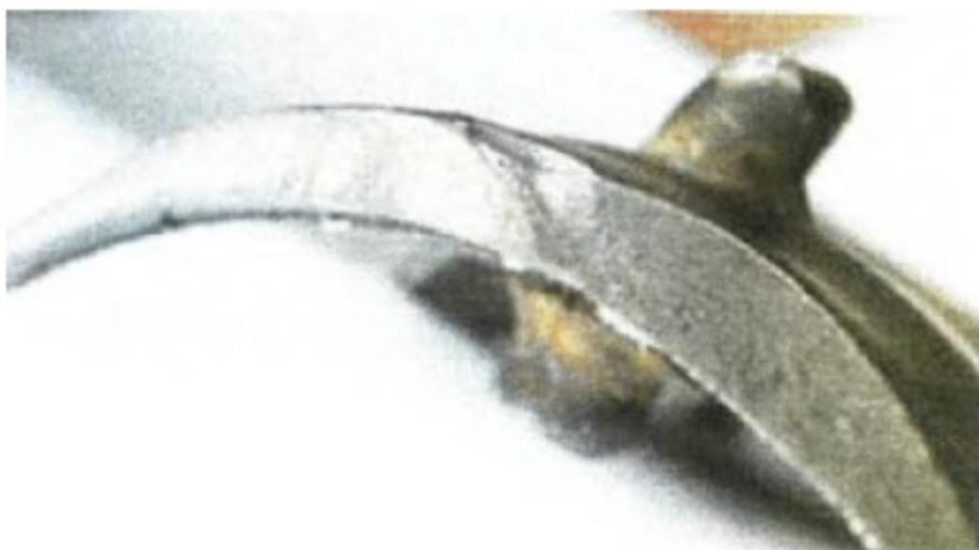
Рис. 1.17. Поверхность разрушения лопатки
