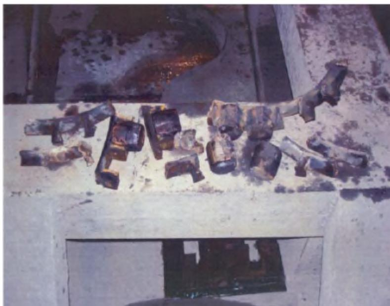
Рис. 1.36. Фрагменты разрушенного подшипника
