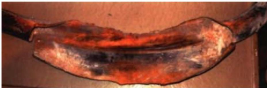
Рис. 1.5. Общий вид продольного разрыва поврежденной трубы
