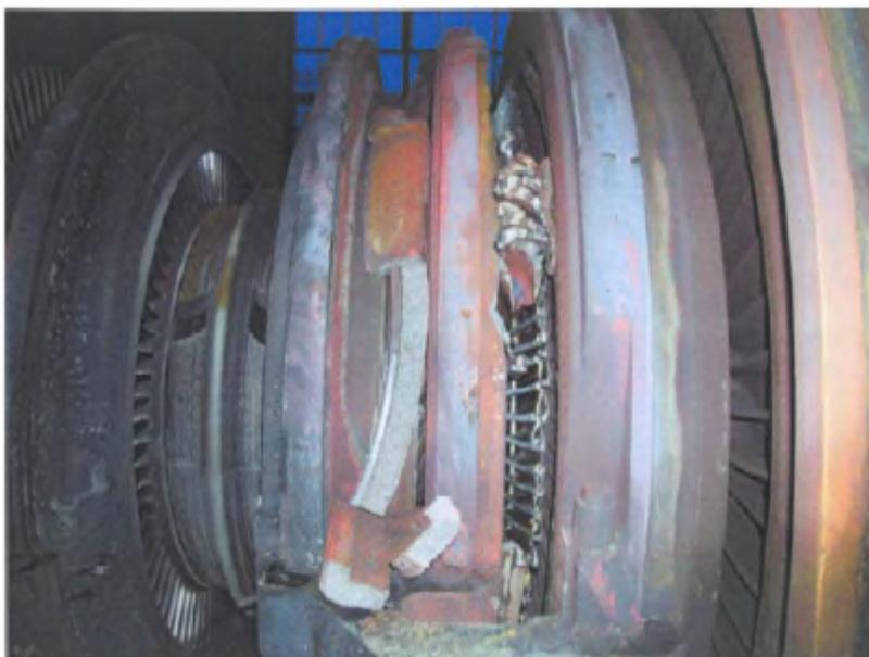
Рис. 1.30. Вид диафрагмы после снятого корпуса
