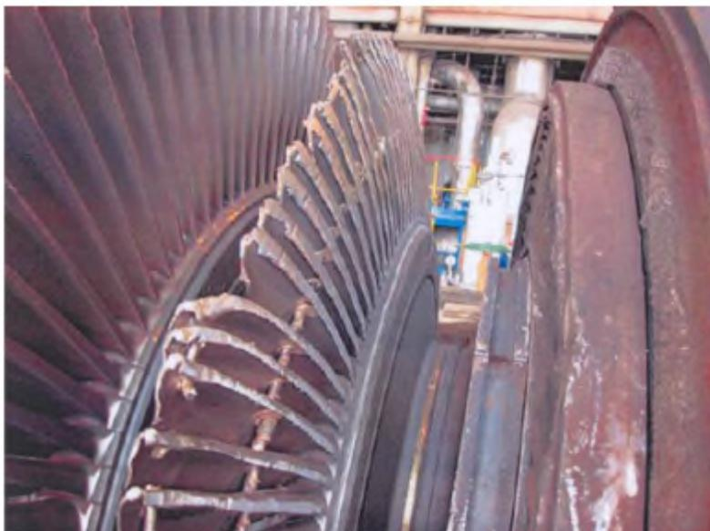
Рис. 1.32. Повреждения лопаточного аппарата
