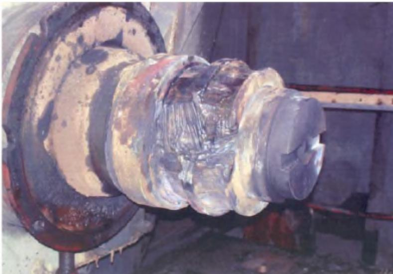
Рис. 1.35. Повреждение подшипника. Вид с торца
