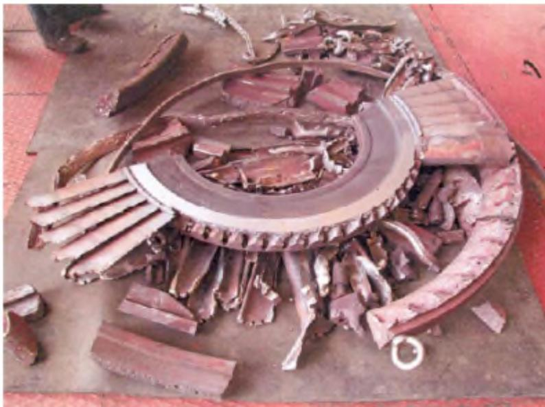
Рис.1.28. Поврежденная диафрагма
