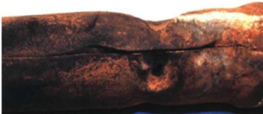
Рис. 1.13. Трещина в змеевике конвективного пароперегревателя
