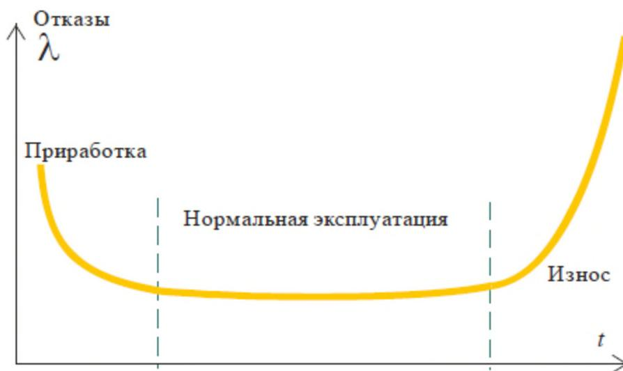
Рис. 8.1. Характеристика надежности эксплуатации и жизни объекта
