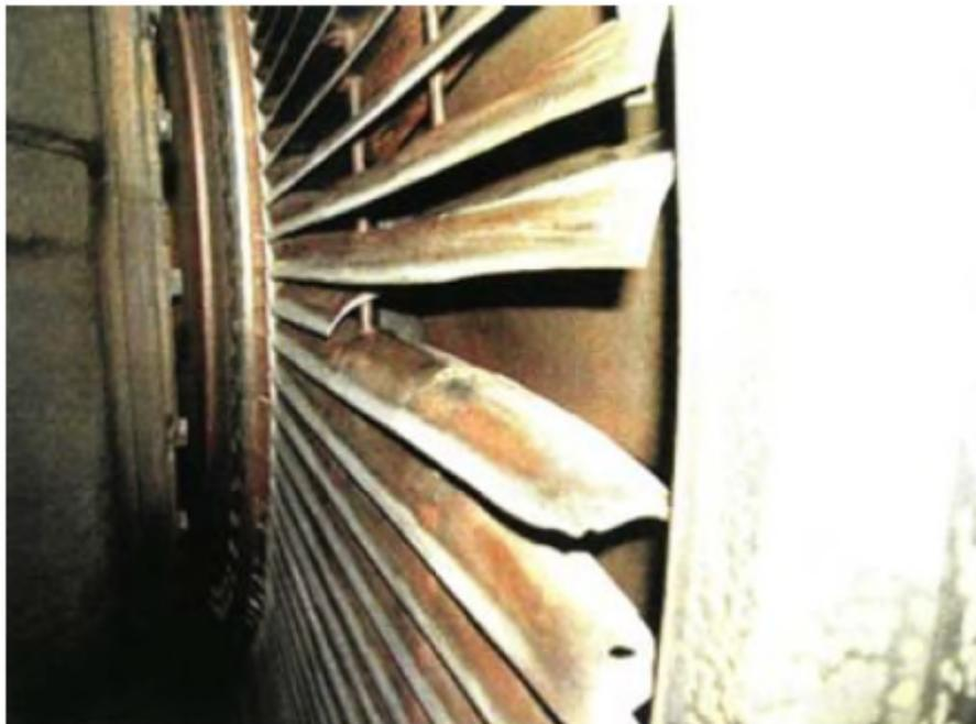
Рис. 1.16. Расположение поврежденной лопатки
