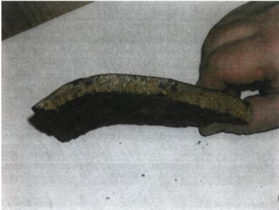
Рис. 1.15. Кусок разрушенного корпуса обратного клапана
