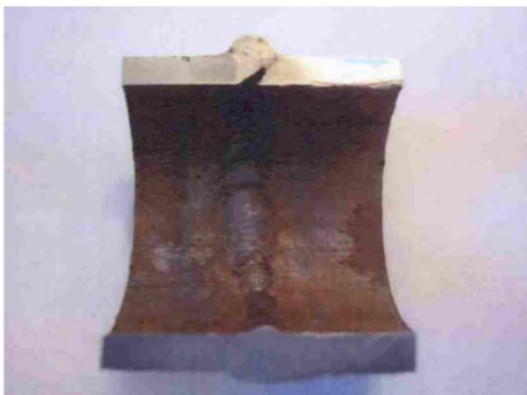
Рис. 1.3. Поперечный разрез дефектного сварного шва со свищом
