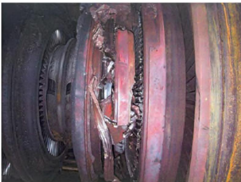
Рис. 1.29. Внешний вид поврежденной диафрагмы
