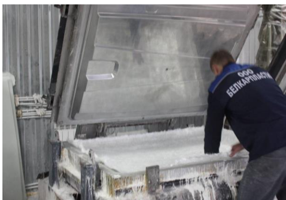
Рис. 5. Укладка армирующего слоя (заготовки из стекломата)
