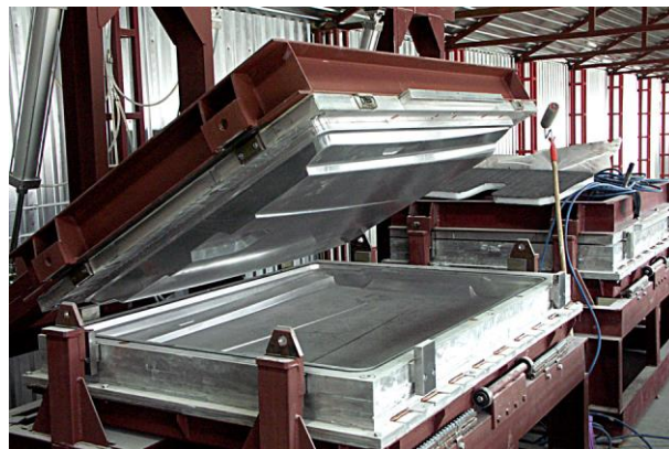
Рис. 2. Пресс-форма для производства крыши тракторов «Беларус» по технологии RTM (ООО «Белкарпластик»)
