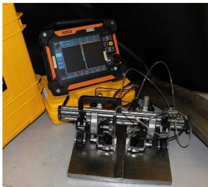
Целью работы является разработка методики проведения механизированного ультразвукового неразрушающего контроля сварных соединений.
