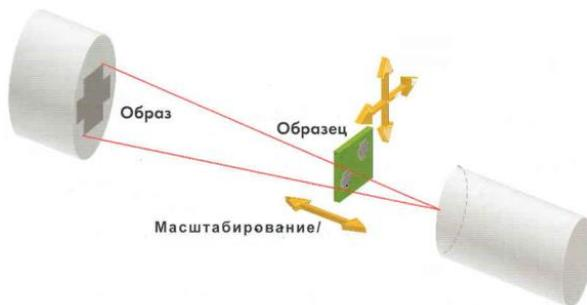
Рис. Схема двухмерного рентгеновского микроскопа
