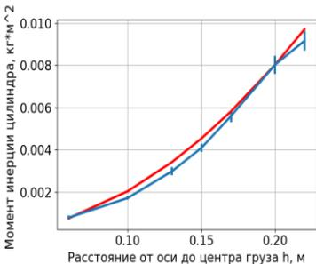
момент инерции всей системы (диска, стержней, грузов) рассчитывался по формуле:  $I = mR^2 \left\{ \frac{gt^2}{2S} - 1 \right\}$ , полученной без учета сил трения. Относительная погрешность измерений рассчитывалась по формуле:
