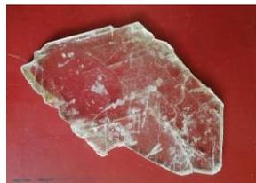
оптическую ориентации пластинок мусковита. Листовой мусковит эффективно используется не только в радиотехнике, но и в оптическом приборостроении. В работе основное внимание уделяется анализу оптической анизотропии исследуемых пластинок при облучении их лазерным и естественным излучением. Для анализа структурных свойств данных пластинок использовались методы поляризационной оптики.
