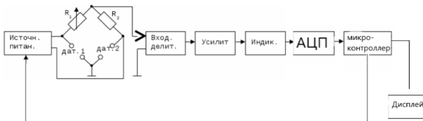
Рис. Функциональная схема тензодатчика, встроенного в эллипсоид
