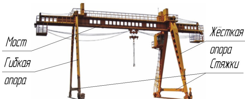
Рисунок 3 – Общее устройство козлового крана КК-К-20
