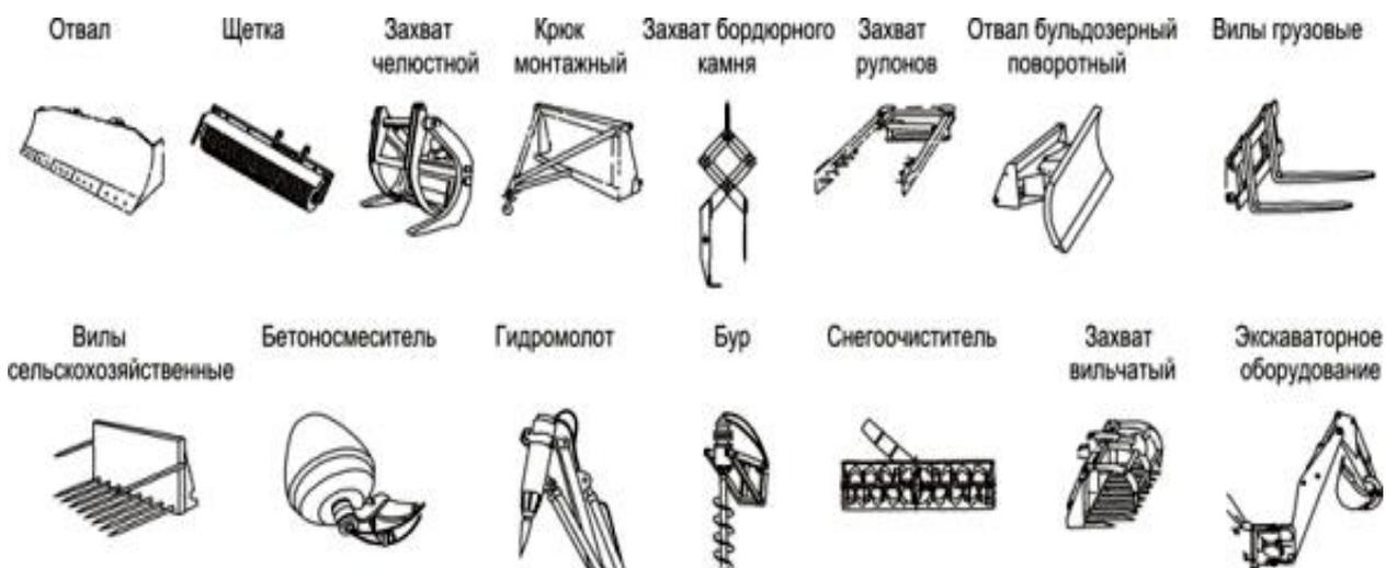
Рис. 3.3. Сменное рабочее оборудование погрузчика «Амкодор 211»
