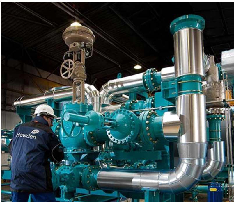
Рисунок 1. Внешний вид компрессора холодильной установки фирмы Howden
