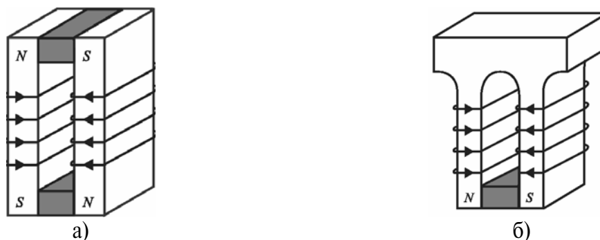
Рисунок 6.10 – Подмагничивание ферритовых преобразователей с помощью постоянных магнитов: а – с установкой двух магнитов; б – с установкой одного магнита
