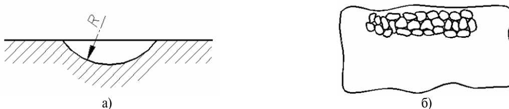
Рисунок 1.3 – Характер разрушения поверхности заготовки при электроэрозионной обработке: а – при воздействии единичного импульса; б – при воздействии серии импульсов
