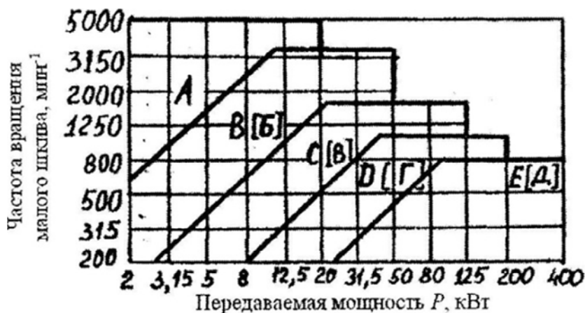
Рис. 2.2. Рекомендуемые сечения ремней
