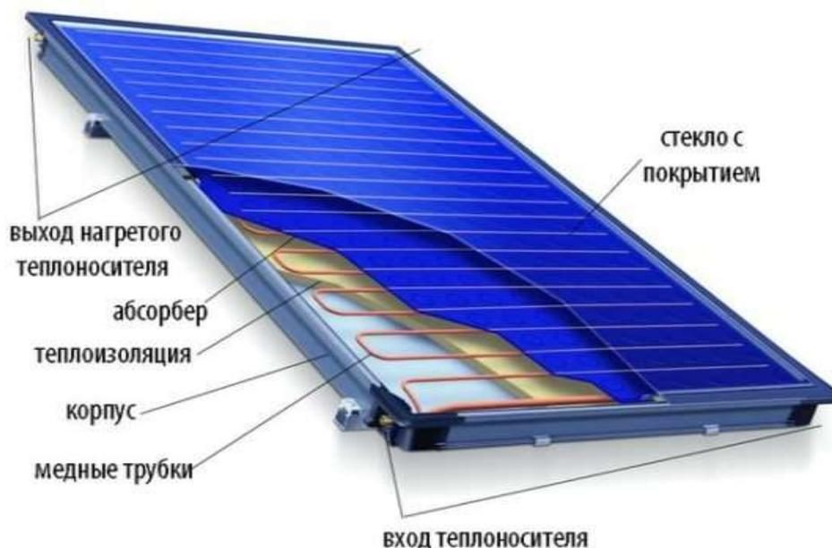
Рисунок 3 – Общий вид плоского гелиоколлектора
