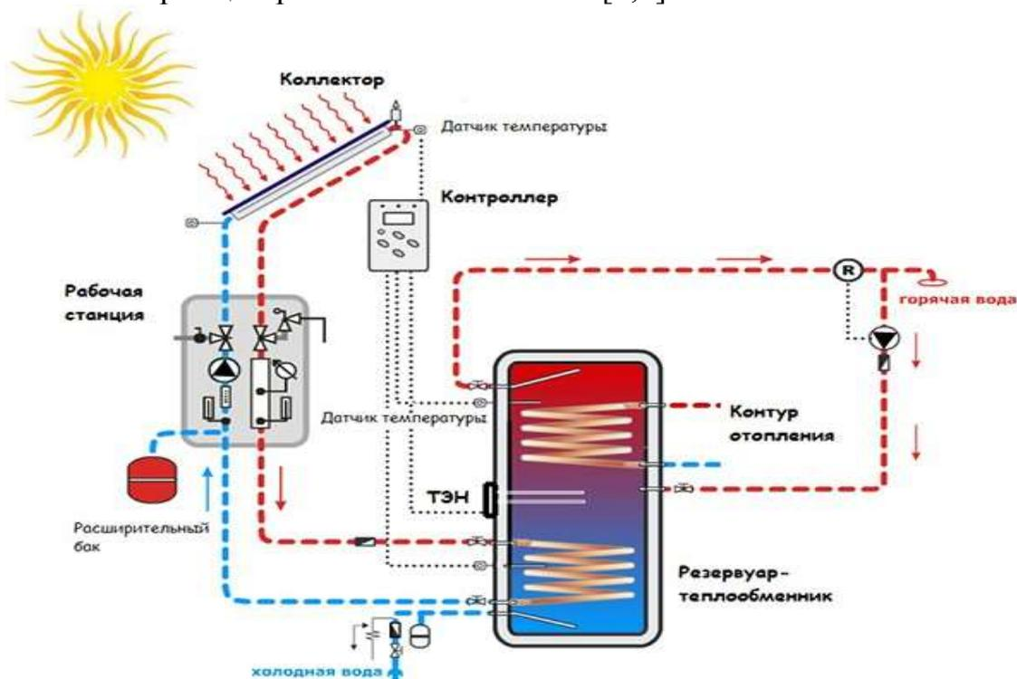
Рисунок 1 – Типовая схема и принцип работы гелиосистемы
