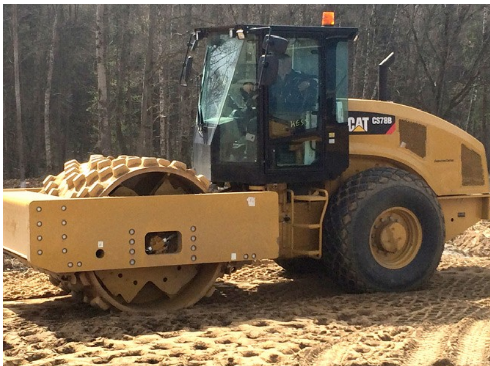
Рис.7.11 – Кулачковый каток для уплотнения глинистых грунтов
