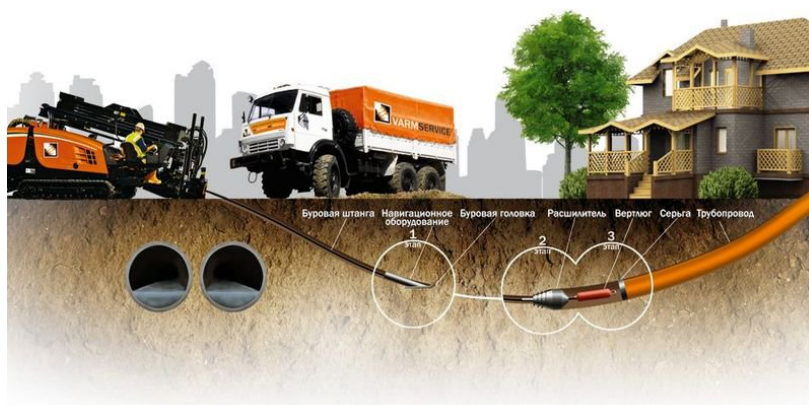
Рис. 8.17 - Установка наклонного направленного бурения
