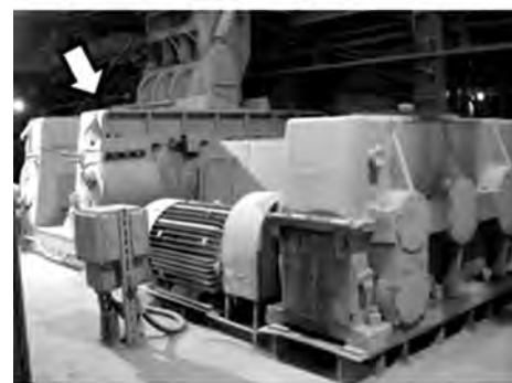
Рис. 1. Пресс валковый для прессования хлористого калия типа ПВП (а) и тот же пресс валковый с приводом, установленный в отделении грануляции СОФ ОАО «Беларуськалий» (б)
