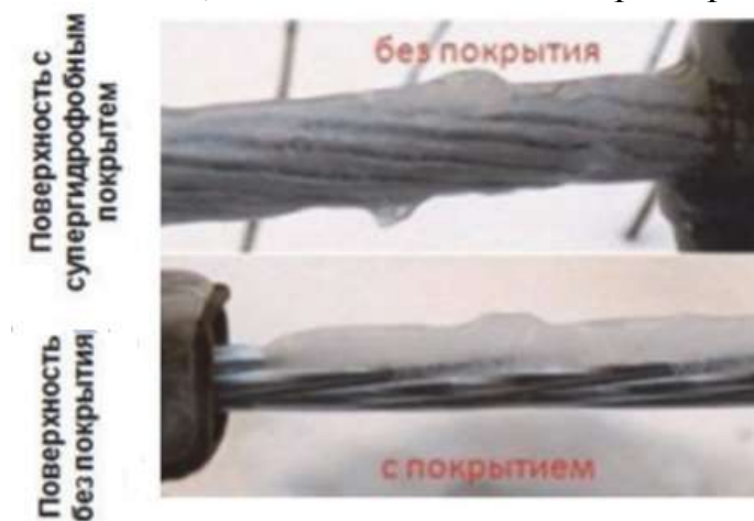
Рисунок 5. Испытания супергидрофобных покрытий в потоке водного аэрозоля при температуре -5^{\circ}\text{C} и скорости ветра 10\text{ м/с}
