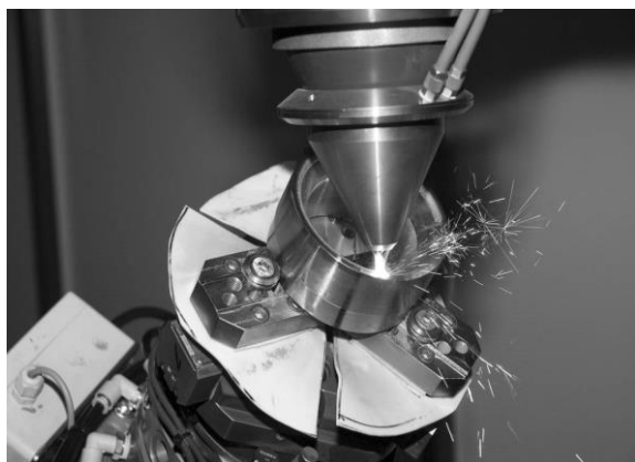
Рисунок 4 – Установка для лазерного структурирования Источник: [1]
