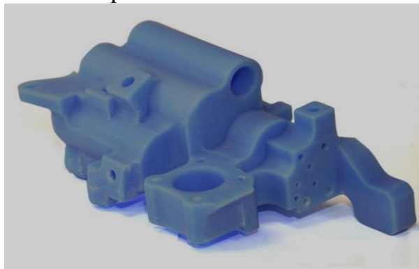
Рисунок 2 – Пример 3D модель из воска Источник: разработка авторов на основе [3, 4]
