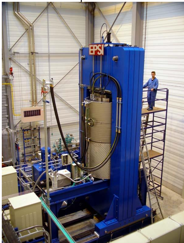
Рисунок 2 – Пресс для теплого прессования
