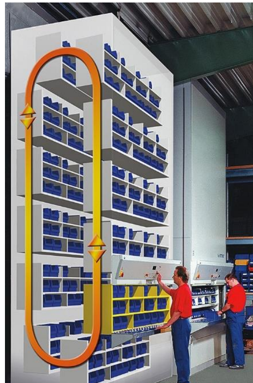
Рисунок 2 – Стеллажная конструкция карусельного типа
