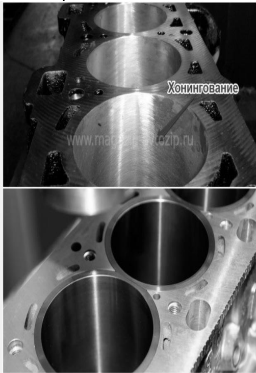
Рисунок 4 – Качество поверхности после хонингования Источник: [1]
