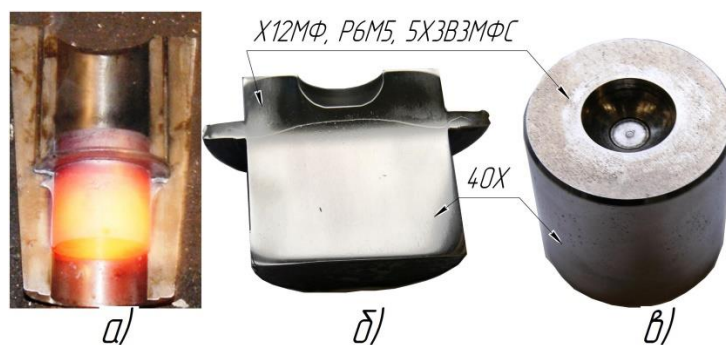
а) – поковка детали «вставка пуансона»; б) – шлиф детали «вставка пуансона»; в) – вставка пуансона после операции шлифования
