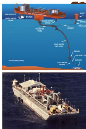
Рис. 2.139. Схема реализации и оборудование технологии ОТЕС с закрытым циклом
