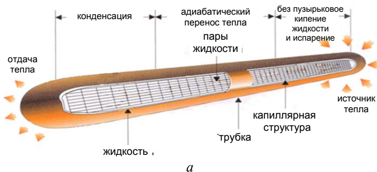
Рис. 4.21. Схема работы тепловой трубы
