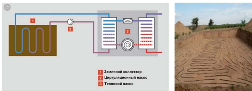
Рис. 2.109. Схема теплового насоса и укладка земляного коллектора
