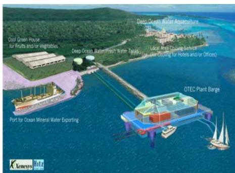
Рис. 2.140. Схема реализации и общий вид технологии ОТЕС с открытым циклом
