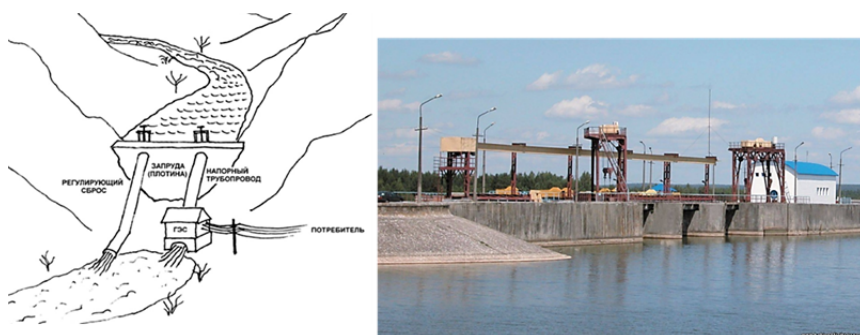
Рис. 2.146. Схема и общий вид плотинной ГЭС
