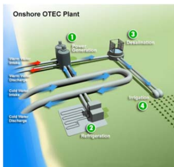
Рис. 2.140. Схема реализации и общий вид технологии ОТЕС с открытым циклом
