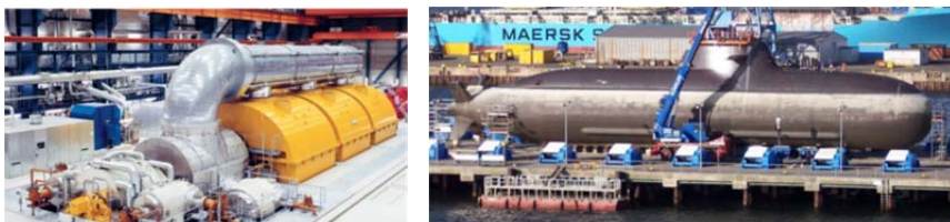
Рис. 3.23. Общий вид газовой турбины для утилизации водорода и подводная лодка класса U212 (Германия) с силовой установкой на водородных топливных элементах
