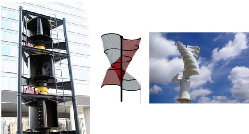
Рис. 2.70. Конструктивные варианты ВЭУ на основе ротора Савониуса
