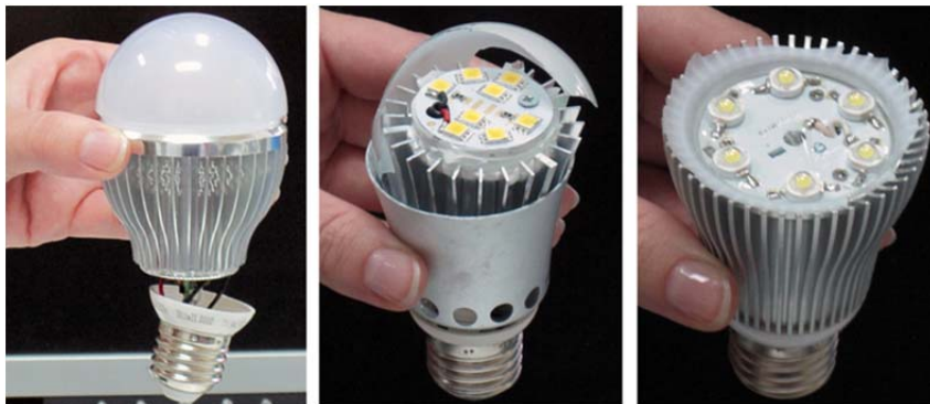
Рис. 4.91. Конструкции светодиодных ламп
