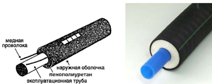
Рис. 1.36. Конструкция и общий вид пластмассовых ПИ-труб
