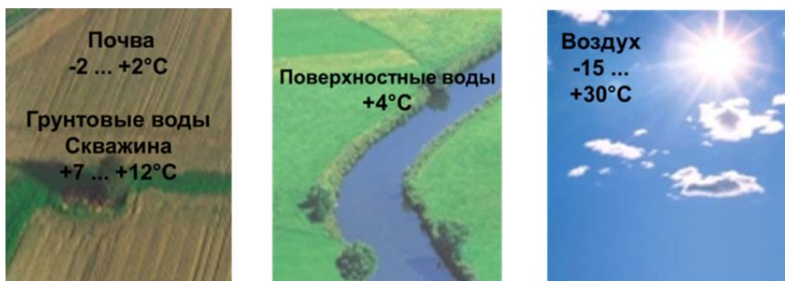
Рис. 2.101. Источники низкопотенциальной энергии для тепловых насосов
