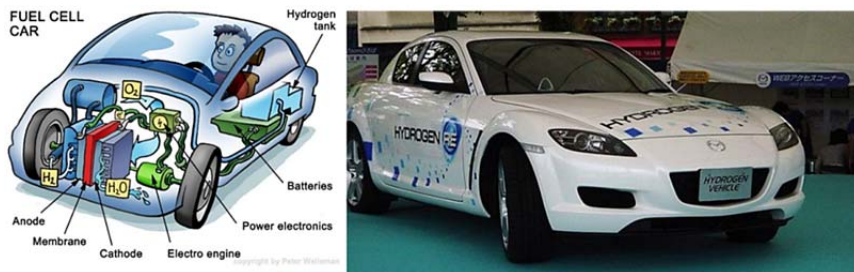
Рис. 3.24. Схематическое изображение и общий вид автомобиля на топливных элементах
