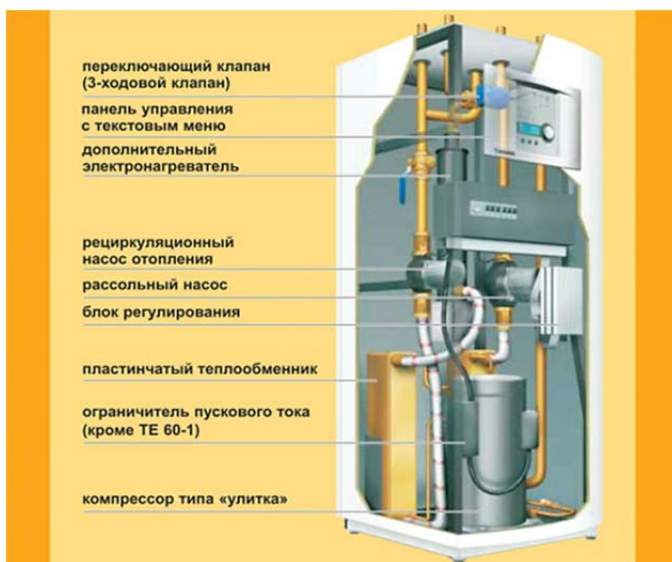
Рис. 2.114. Типовая конструкция теплового насоса
