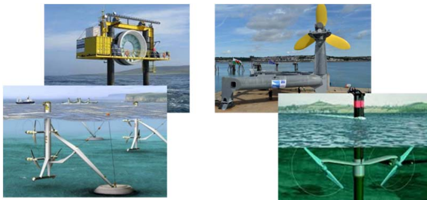
Рис. 2.134. Схема реализации и общий вид оборудования для использования энергии приливов и отливов, морских течений
