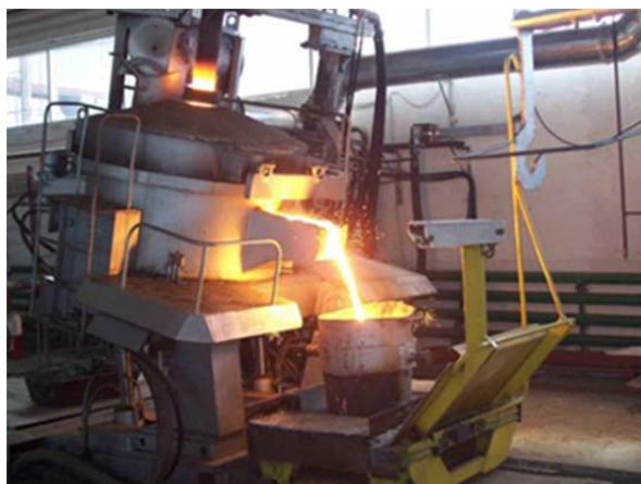
Рис. 4.56. Эффективность применения ( а ) и общий вид ( б ) установки для индукционного нагрева
